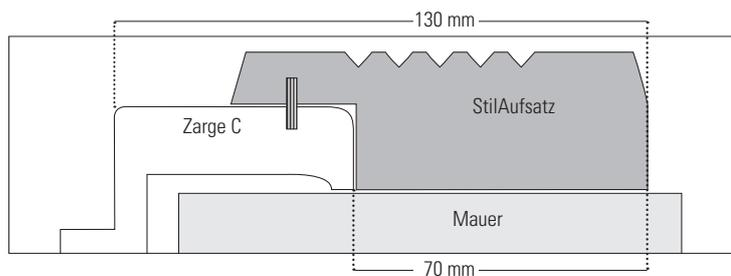
StilAufsätze für entsprechend vorgerichtete Zarge C, MDF V 313 massiv mit gefrästen Linien und Flächen, Verbreiterung der Zargenbekleidung um ca. 70 mm auf ca. 130 mm Gesamtbreite, Oberfläche mit 2-Komponenten-Lack weiß ähnlich RAL 9010 alternativ RAL 9016 verkehrsweiß im Spritzverfahren lackiert. Sockelhöhe 140 mm. Der Öffnungswinkel wird durch das Sockelstück auf 140° eingeschränkt. Wir empfehlen die Montage eines Türstoppers.
