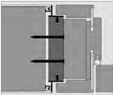
Blindstock für wandbündigen Einbau in Verbindung mit Zarge **duo 55** und **Zarge E**, Schattenfuge 5 mm. 1-flg. oder 2-flg.
